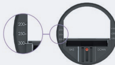
Exemple de réglage à 300 m 3 /h : régulateur calé sur le repère gauche "300"
